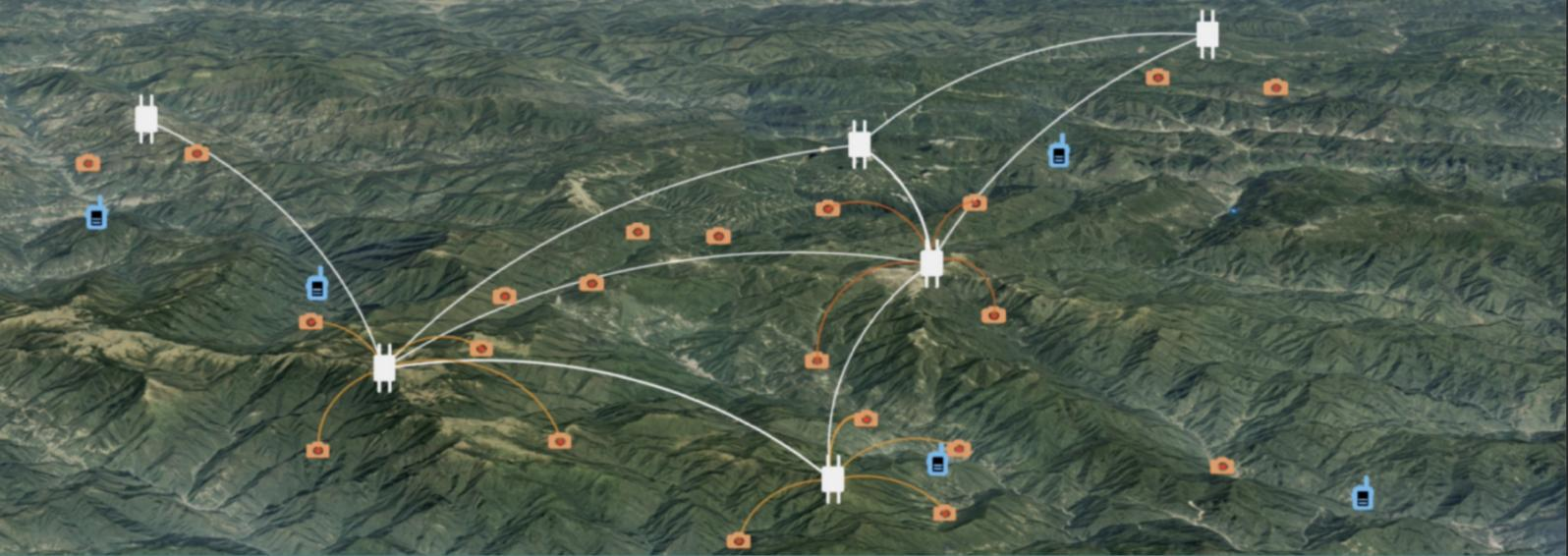
无线自组网基站为自组网红外触发相机、自组网手持终端、传感器等终端设备提供数据传输能力，并通过多跳连接接入骨干通信网络和互联网云平台，从而构成一套完整的无线数据传输系统。
